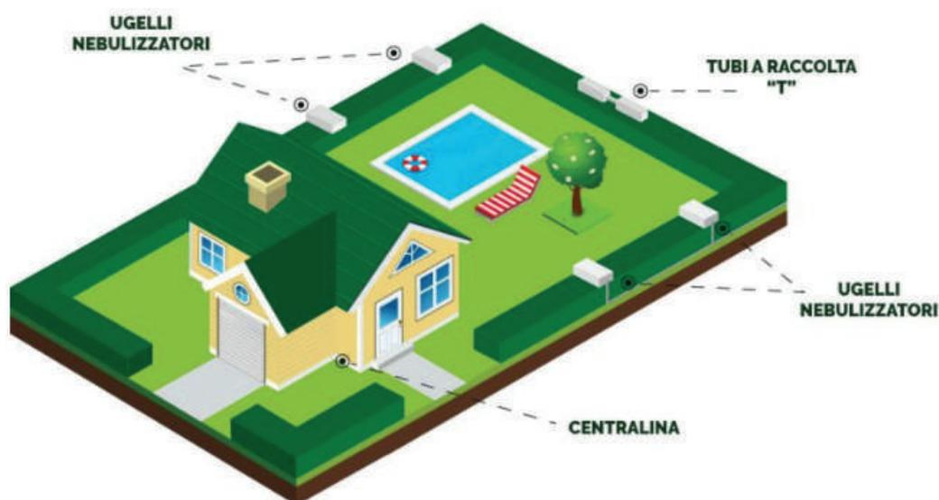
L'installazione è praticamente invisibile; posizionata la macchina, si installano dei piccoli ugelli nebulizzatori nel perimetro della proprietà o nelle zone di interesse collegati con appositi raccordi e specifiche tubazioni.
